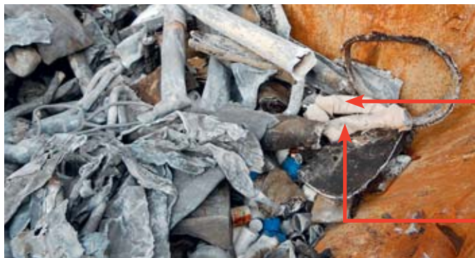
Rohrleitungen mit asbesthaltigem Mörtel
