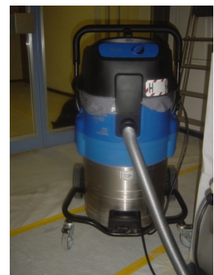
3 Industriestaubsauger mit Filter für Staubklasse H (Asbest)
