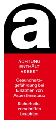
2 Kennzeichen «Achtung Asbest»
